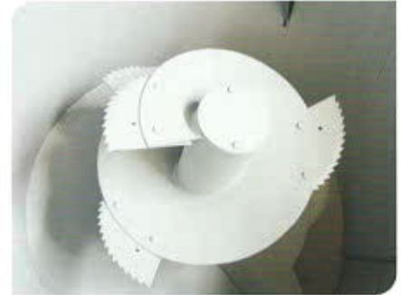
Dikey karıştırıcı, parçalayıcı helezon ve ısıl işlem görmüş bıçaklar
